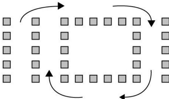
Die Reihenfolge der Ein- und Ausfahrten kann beliebig gewählt werden. Das Schneckenhaus kann von „innen nach außen“ oder auch umgekehrt befahren werden. Auch ein spiegelbildlicher Aufbau ist möglich.
